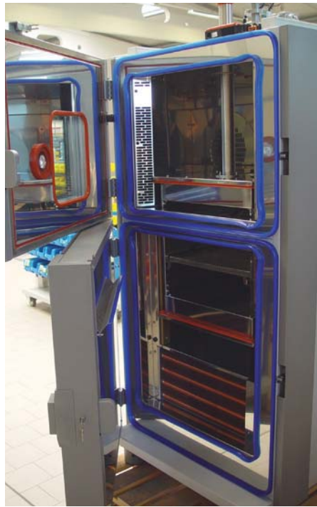
Bild 2: In den Klimakammern herrschen Temperaturunterschiede bis zu 300°C
