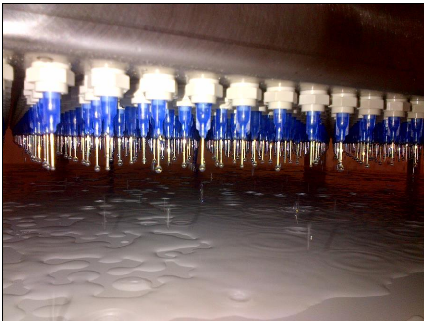
Tropfenbildung an einem Tropfgerät der Serie TG
